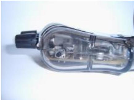
Der Taster wird im Digitalbetrieb zum Spurwechseln verwendet. Im Analogbetrieb kann mit diesem Taster eine Vollbremse ausgelöst werden.
